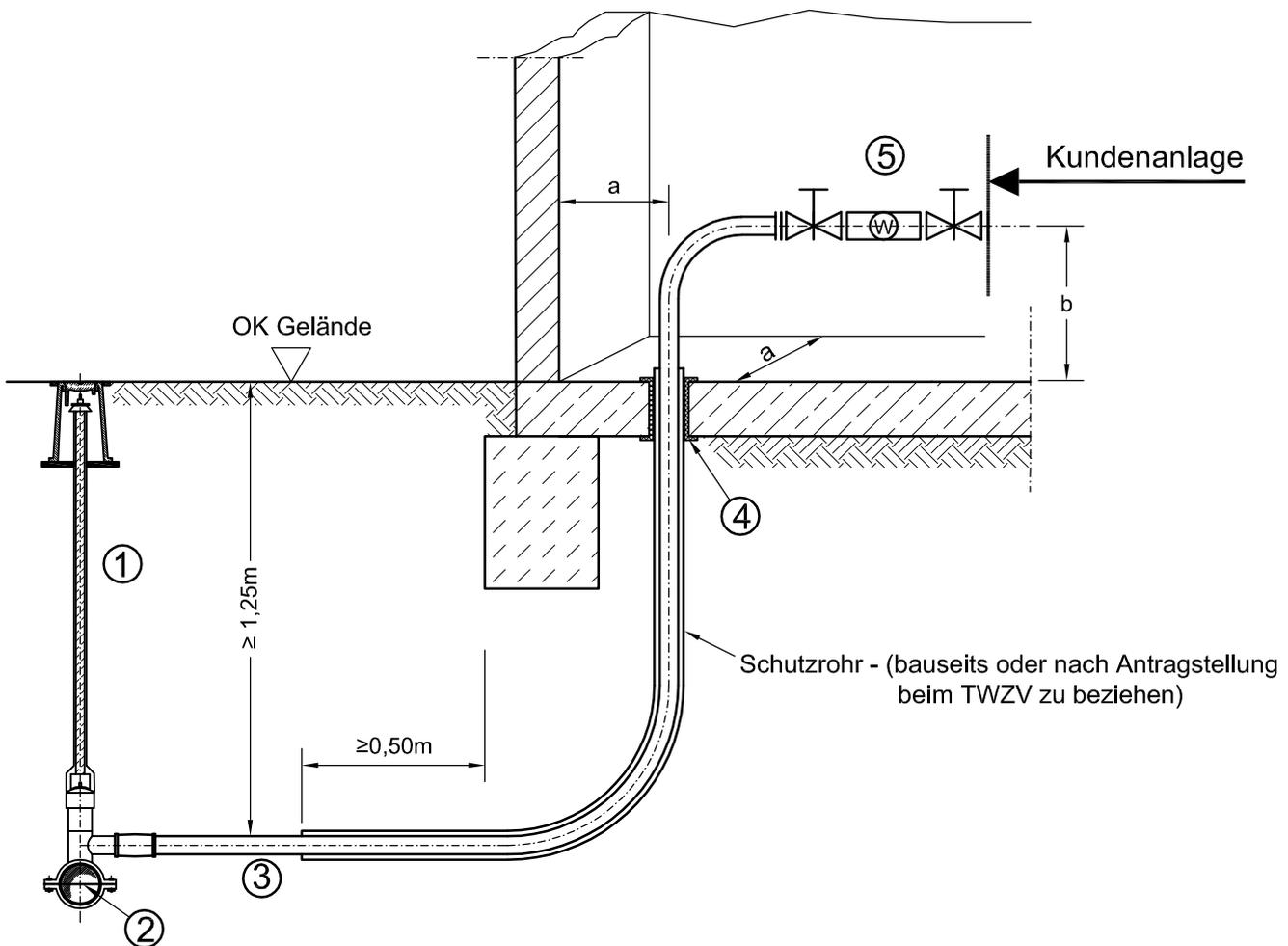
① Anbohrarmatur: Straßenkappe, Gestänge im Schutzrohr, Ventilanbohrschelle
